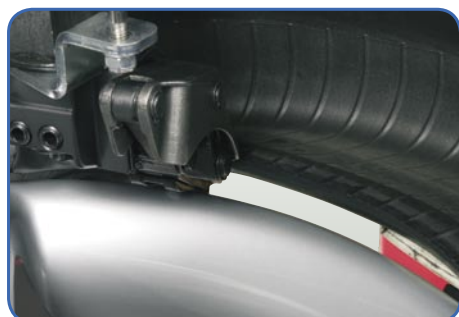
➤ Procedura standard di smontaggio del tallone inferiore con torretta Standard bottom bead demounting procedure with mount/demount head
